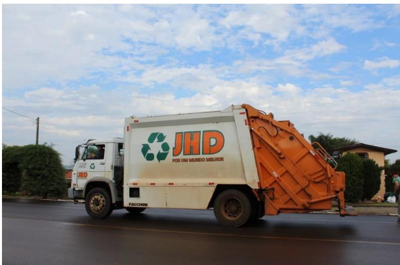
Figura 01. Modelo de caminhão utilizado para a coleta de resíduos comerciais e domiciliares.
